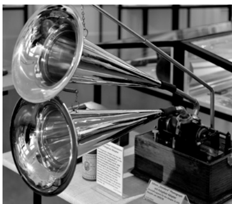
Edison Standard Phonograph mit Polyphon Adapter, 1899/1900. Der zweite Trichter dient zur Klangverstärkung. Da die Tonabnahme der beiden Trichter nicht an der gleichen Stelle erfolgt, entsteht eine geringe Phasenverschiebung.
